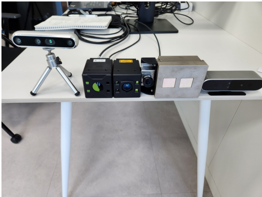
그림 3. 검증에 사용한 상용 3D 센서 5종 - ToF 3종, 구조광 1종, 액티브 스테레오 1종
