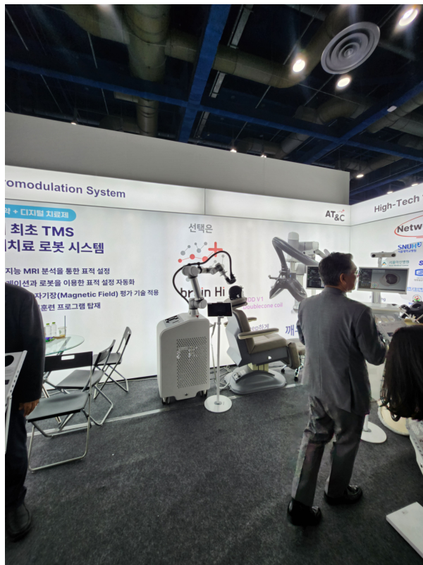
그림 1. 전시 부스의 TMS 코일 내비게이션 로봇 시스템 시연입니다 - 로봇 암, 치료 의자, 코일, 내비게이션 화면이 한자리에 놓인 구성.
