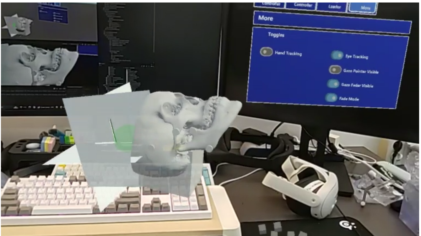
그림 7. HoloLens 공간 표시와 손-시선 상호작용 토글.
