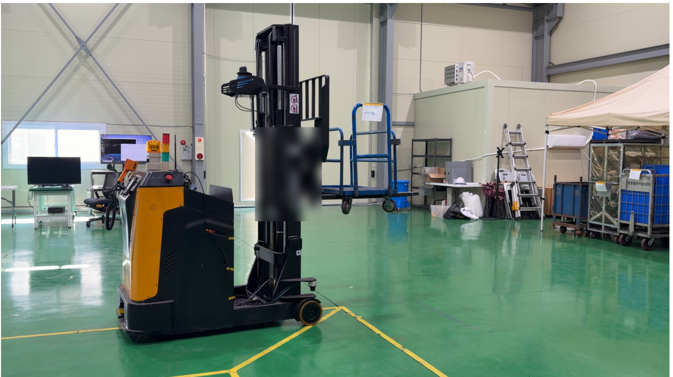
그림 4. 포크 승강 테스트 - 카트 들어올리기
